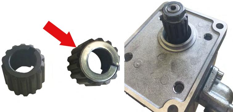
Montieren Sie den Hydraulikadapter auf der Druckseite des Motors. Die Druckseite ist die Seite, auf der der Druckbegrenzer des Motors sitzt. (Siehe roter Pfeil im Bild.)
