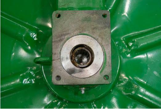
Die Profilhülse wird an der Welle des Hydraulikmotors montiert. Verwenden Sie die Federscheibe und Mutter von der Welle des Hydraulikmotors.
