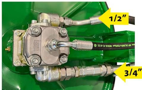
**Wichtig!** Stellen Sie sicher, dass der Rücklauf korrekt angeschlossen ist. Schließen Sie den Rücklauf an den freien Rücklauf an.
