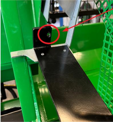
Schieben Sie die Kettensäge so hinein, daß der untere Dorn im Loch endet.
