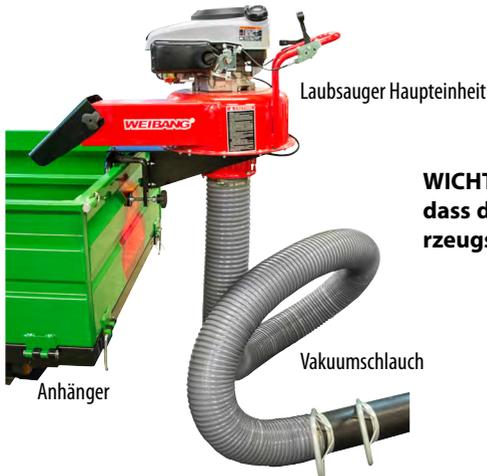
**WICHTIG!** Stellen Sie vor der Benutzung sicher, dass das Gerät fest auf der Ladefläche des Fahrzeugs montiert ist!
