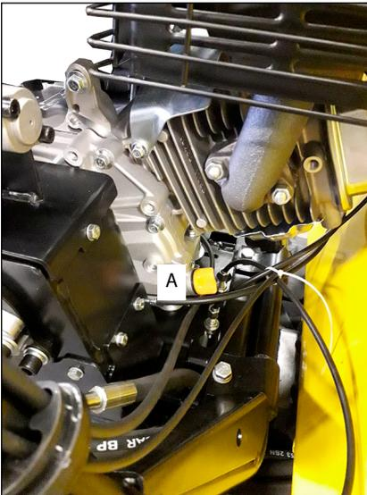
Füllen Sie Motoröl SAE 15W-40 in eine der beiden Einfüllstellen ein, *siehe A*.
