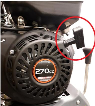
Ziehen Sie den Startergriff langsam an, bis der Mechanismus Widerstand bietet, danach ziehen Sie Sie schnell am Griff.
