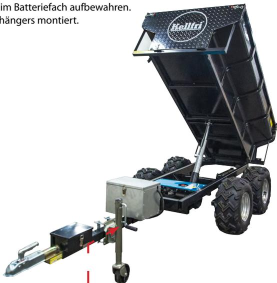
Montieren Sie das Batteriefach an der Deichsel des Anhängers. Vergessen Sie nicht alle Schrauben anzuziehen und vergewissern Sie sich, dass das Fach gut arretiert ist.
