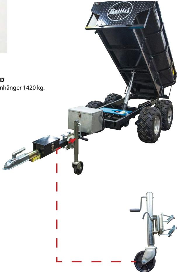
Montieren Sie die Stütze an der Deichsel des Anhängers. Warnung vor Quetschgefahr während der Montage! Stellen Sie sicher, dass die Deichsel gesichert ist und sich keine Körperteile zwischen Deichsel und Boden befinden. Es dürfen sich keine Personen unter der Deichsel befinden, wenn diese angehoben ist. Ziehen Sie alle Schrauben an und stellen Sie sicher, dass die Stütze fest sitzt. Kurbeln Sie die Kurbelstange, um die Stütze zu absenken oder anzuheben.
