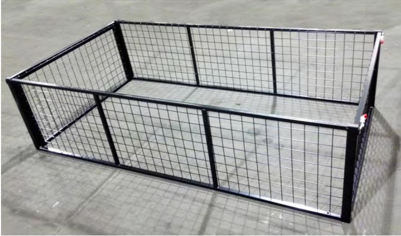
1. Sichern Sie die kurzen Seiten mit den Ladeflächenarretierungen. Heben Sie anschließend das zusammengebaute Gitter auf den Anhänger und markieren Sie alle vorzunehmenden Bohrungen. Heben Sie das Gitter an und bohren Sie Löcher in das Anhängerprofil. Es besteht auch die Möglichkeit, die Position der Löcher zu vermessen, Löcher zu bohren und anschließend Bordwanderhöhungen mit Schrauben am Anhänger zu befestigen. Ziehen Sie dann alle Schrauben fest.
