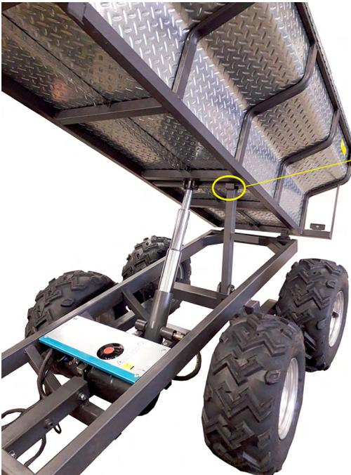
**Stütze** Am Fahrwerk montiert. Einfach hoch- und herunterzuklappen. Wichtig! Stellen Sie vor dem Einbau des Zylinders sicher, dass die Stütze fest im Rahmen eingerastet ist.
