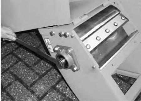
3. Drehen Sie den Häckselzylinder von Hand, bis eines der beiden Häckselmesser durch die Öffnung des Zylindergehäuses zu sehen ist.
