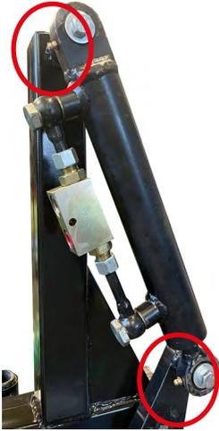
Schmieren Sie alle Schmierpunkte mit Fett: Gelenklager am Zylinder und Zylinderaufnahme.
