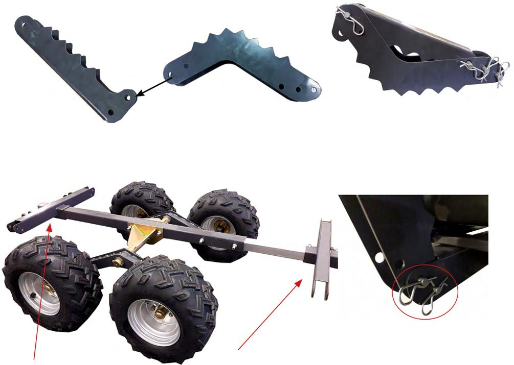
Stützen werden verwendet, wenn die Ladefläche nicht montiert ist.
