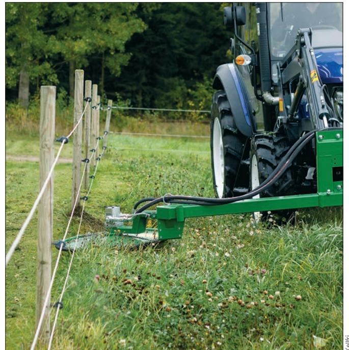
Der Zaunmäher reicht dank seines flachen Mähaltellers auch unter 20 Zentimeter hohe Drähte.
