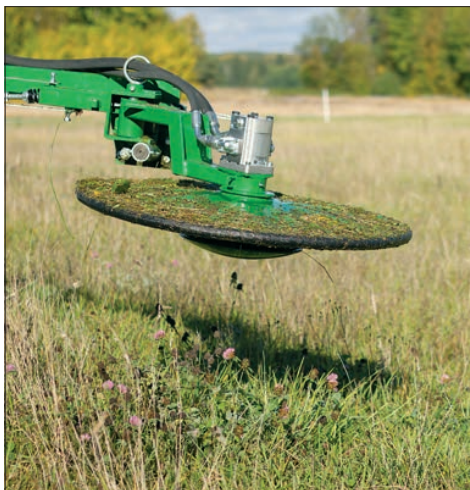
Ein Parker 25 ccm Hydraulikmotor treibt die Messer an.
