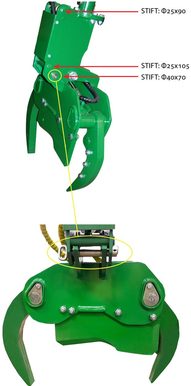
Wenn Sie den Fällgreifer ausschließlich als Greifer einsetzen möchten, montieren Sie den Stift gemäß Abbildung.
