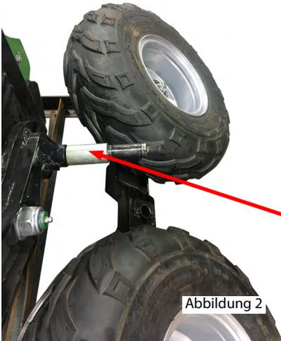
Die Hülse ist an das Inner des Drehgestells zu montieren.
