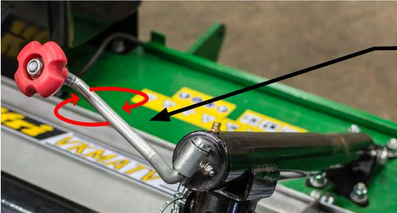
Die Schnitthöhe lässt sich durch Drehen der Kurbel nach rechts anheben und nach links absenken.
