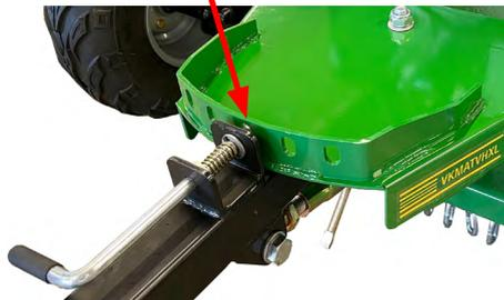
Der Winkel der Zugstange kann durch Herausziehen des Hebels schnell eingestellt werden. Ziehen Sie den Hebel heraus, stellen Sie den gewünschten Winkel durch Drehen ein und bringen Sie den Hebel wieder an.
